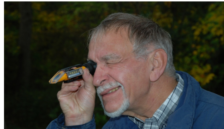
Ermittlung des Oechsle-Grades mit dem Refraktometer
